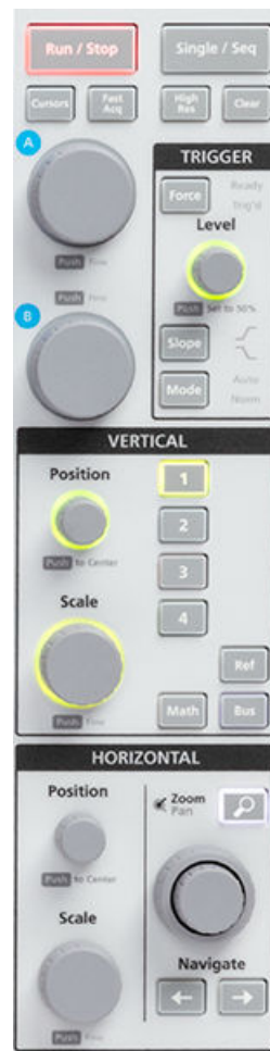
高效直观的前面板（图示为 DPO714AX）提供了关键控件，同时为 15.6" 大型高清显示器留出了空间。
