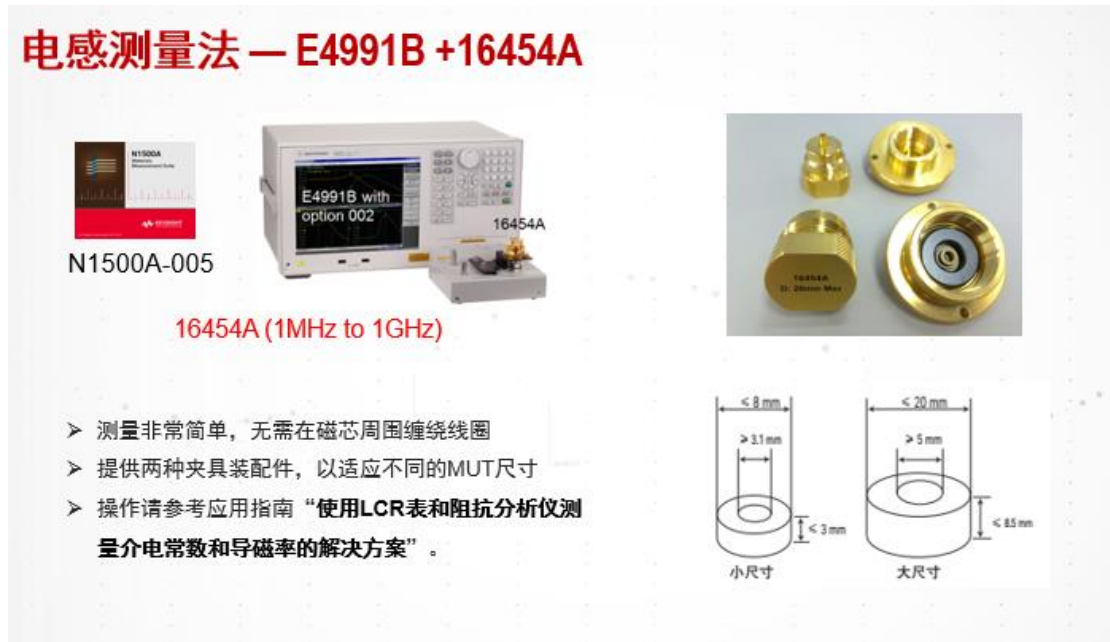
图 9. E4991B 搭配 16454A 进行磁导率测试
