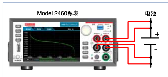
图 12. Model 2460 源表 SMU 仪器的图形显示器上显示的电池放电结果。
